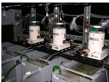
↑電気生理測定機器： 魚類の感覚神経や脳表面からの 電位を測定する装置。
