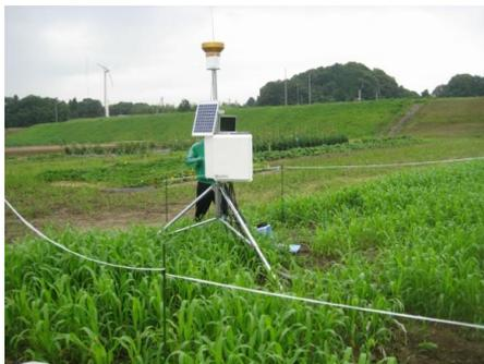
スーダングラス圃場に設置した土壌水分モニタリングシステム
