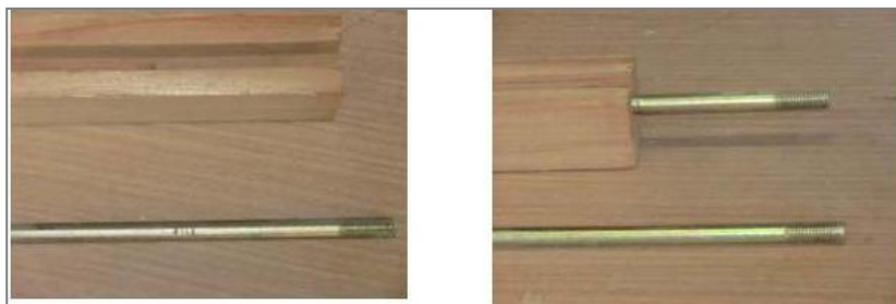
↑ 曲げ強度改善を目的とした木金複合部材の開発
