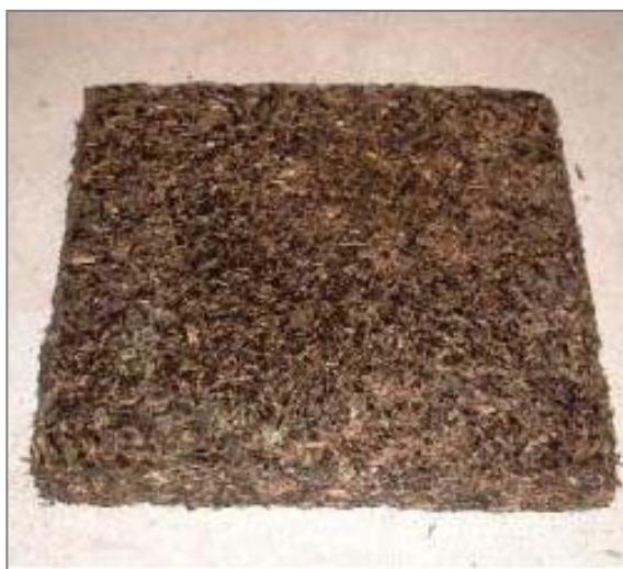
↑ 建築廃材を利用した木質道路舗装材
