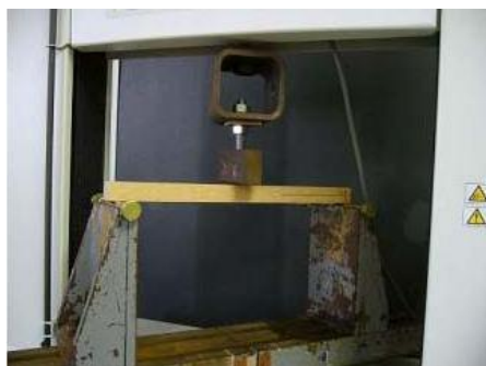
↑ 3ENF試験によるモードII破壊靱性値の測定 DCB試験体と同一形状の試験体であるため、モードIとモードIIの破壊靱性値を連続して測定できる可能性がある。
