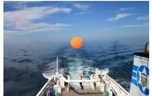
↑ 勢水丸からのラジオゾンデを放球の様子 黒潮などの海の影響を受けた海上の気象を探るために、勢水丸から気球(ラジオゾンデ)を上空に放球し、洋上の高層の大気の観測も行っている。陸上でもラジオゾンデを放球し高層大気の観測を行っている。(三重大学全学シーズ集HPより)
