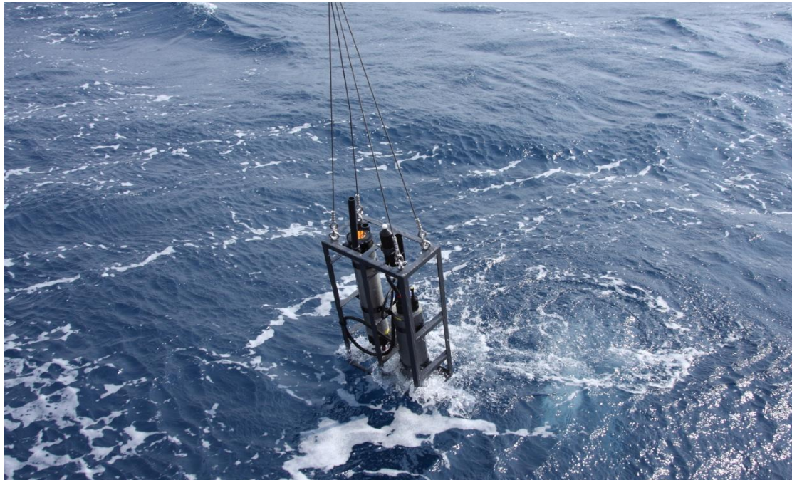
FRRF (高速フラッシュ励起蛍光光度計) による海洋の一次生産速度の測定
