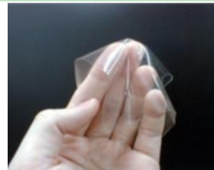
有機・無機複合化技術により作製された厚さ100μmの透明シート
