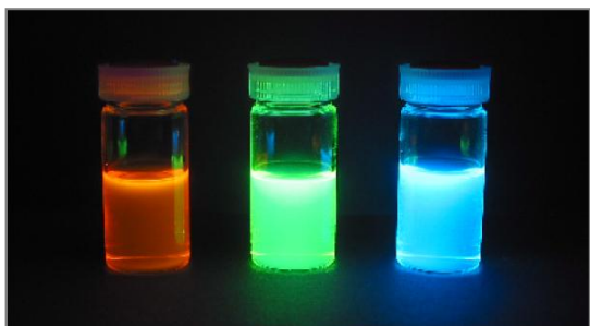
紫外線の照射によって発光する有機ポリマー。このようなポリマーとガラスとのハイブリッドは新しい光学材料として期待される。
