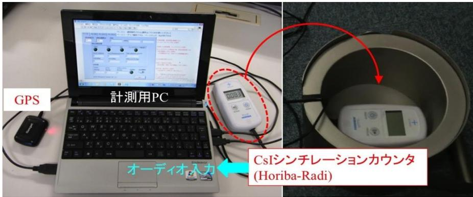
小型軽量放射線計測器の外観。食品等の放射能測定時には、環境放射線遮蔽用の鉛容器内で測定を行います。
