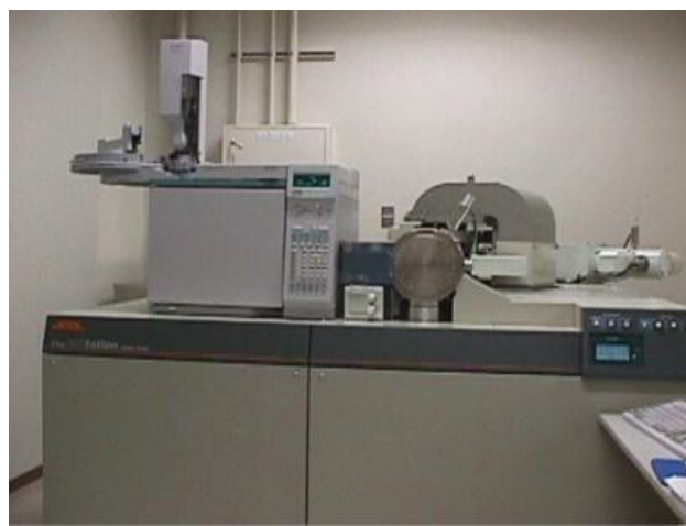
高分解能ガスクロマトグラフ質量分析計→ ※画像は三重大学全学シーズ集HPより
