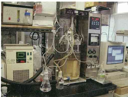
図1 バイオリアクターによる微生物の培養(生分解性洗剤の発酵生産)
