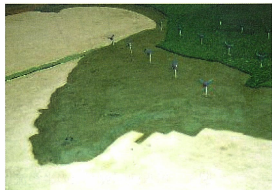
図2 地形モデルの風洞実験
