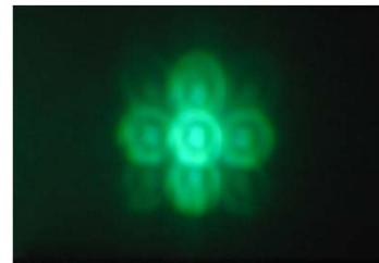
試作した回折格子によるLED配光制御
