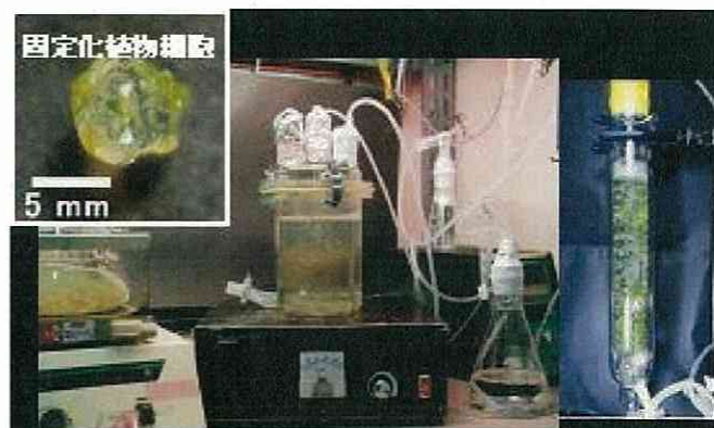
図2 試作した植物用リアクター(クローン植物の素を生産)
