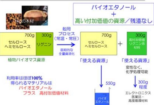
**図1: 相分離系変換システムと分離変換された植物バイオマス構成成分**
