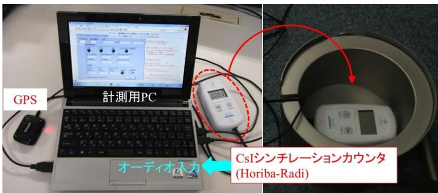
小型軽量放射線計測器の外観。食品等の放射能測定時には、環境放射線遮蔽用の鉛容器内で測定を行います。
